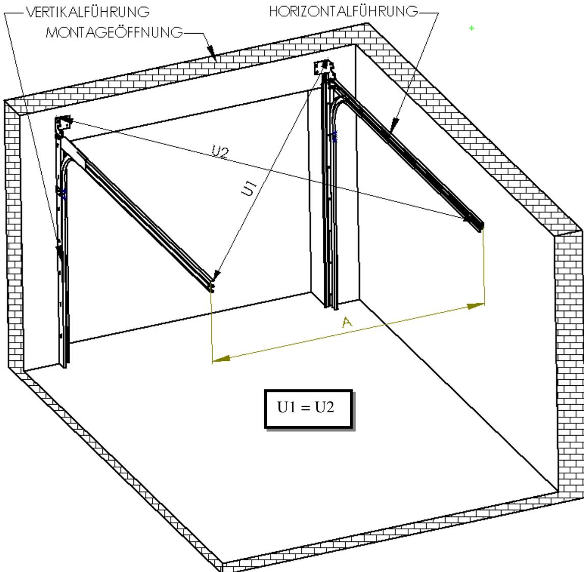
**Beide Horizontalschienen** mit Hilfe des Montagewinkels (am Schienenende) und der mitgelieferten Hilfskonsolen in die Decke in der ganzen Schienenlänge befestigen.
