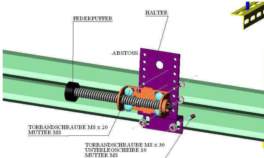
**Lange Federpuffer** helfen beim Anlauf des Torflügels aus der Öffnungsposition (Wellenantrieb) und werden gemäss dem geöffneten Tor eingestellt.
