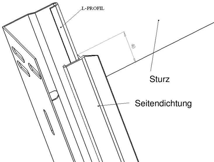
**Mass A** bestimmt den Abstand der Vertikallaufschienen.
