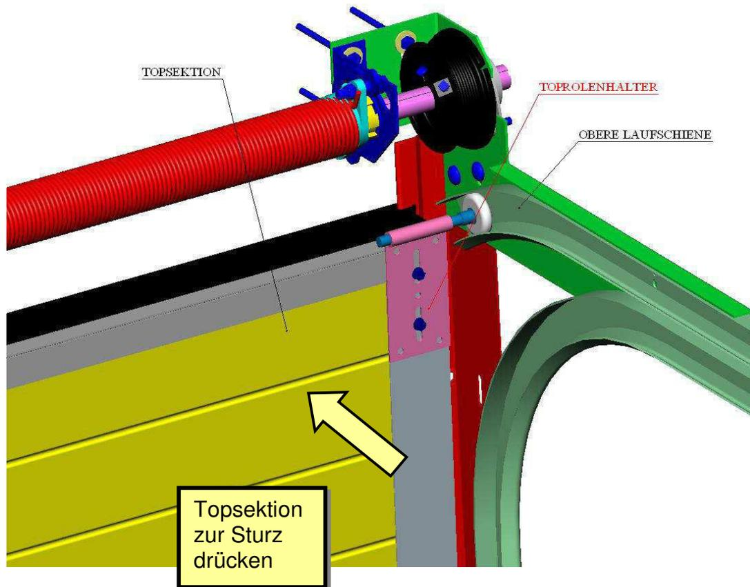
Paneele ausrichten (Wasserwaage) und fest zusammenschrauben (Seiten- und Mittelscharniere).
