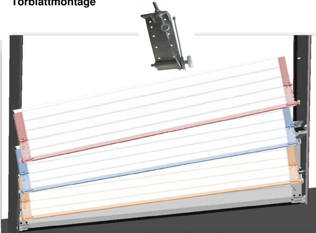
Das vorgefertigte Bodenpaneel in die Vertikalführungen (ohne rechte Rolle) setzen, rechte Rolle getrennt in die Führung schieben und dann mit rechter Bodenkonsole verbinden. Achten Sie darauf, dass das Bodenpaneel richtig zentriert und **waagrecht** ist. Falls der Boden noch nicht fertig ist, Bodenpaneel in der Waage ausrichten und in der ganzen Länge unterlegen.
