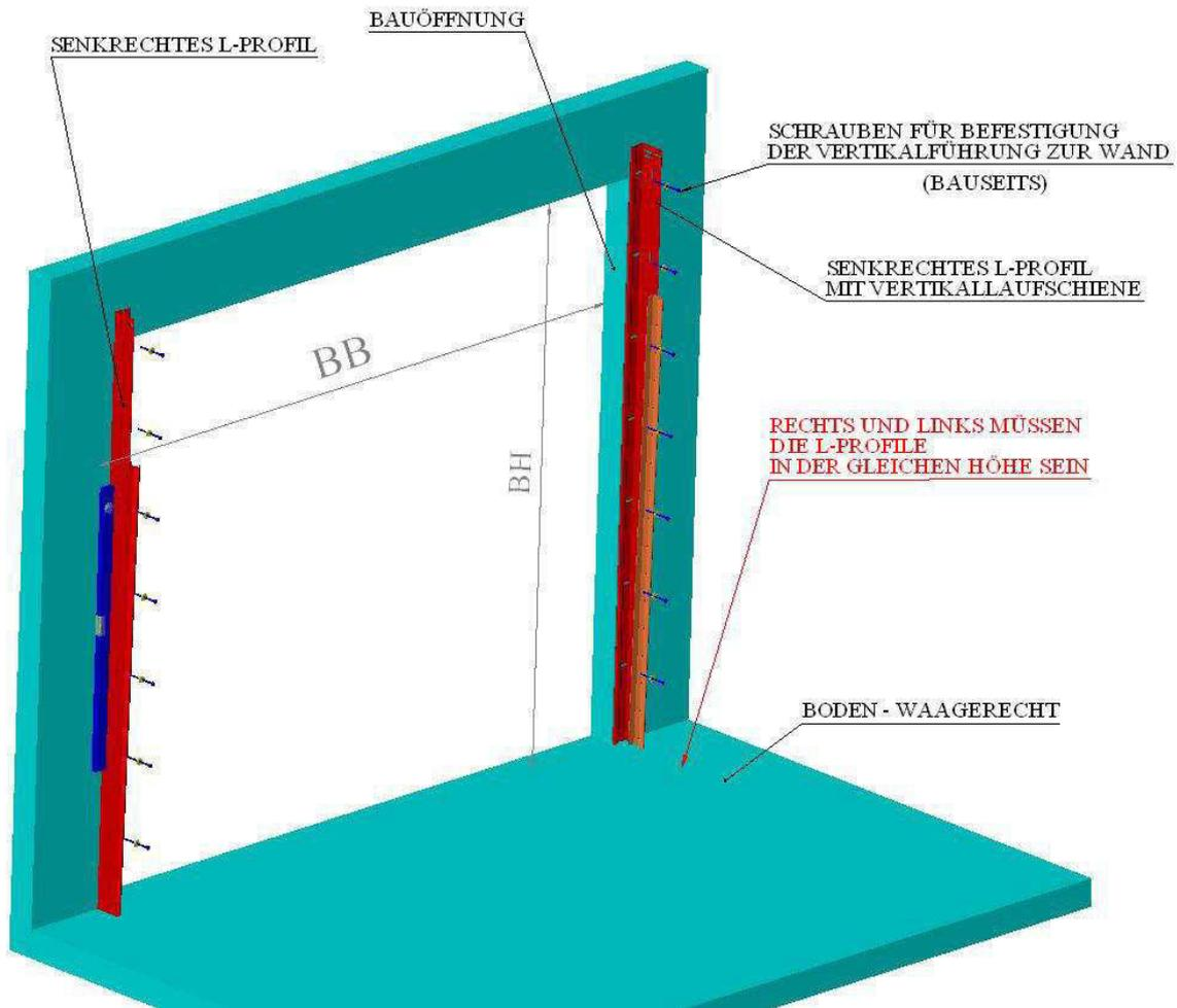
Beide Seitenzargen in gleicher Höhe zur Bauöffnung anlegen und die Position der Befestigungslöcher markieren.
