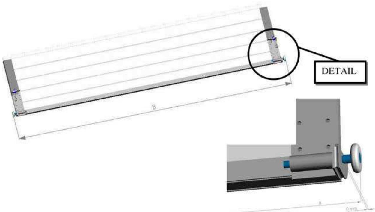
Berechnung des **Masses A = Abstand der Vertikalschienen:**
