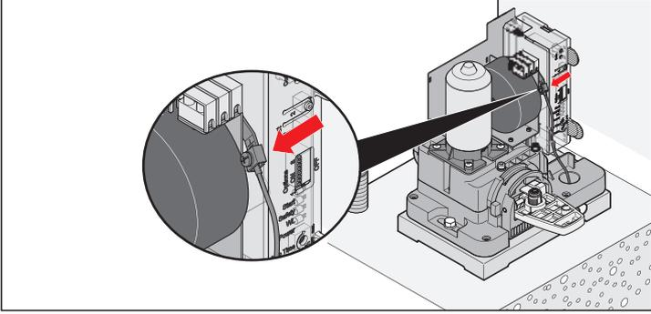
1. Die an der Konsole (Montageplatte werksseitig vormontierte Erdungslitze an der Erdungsklemme (siehe Grafik) anbringen
