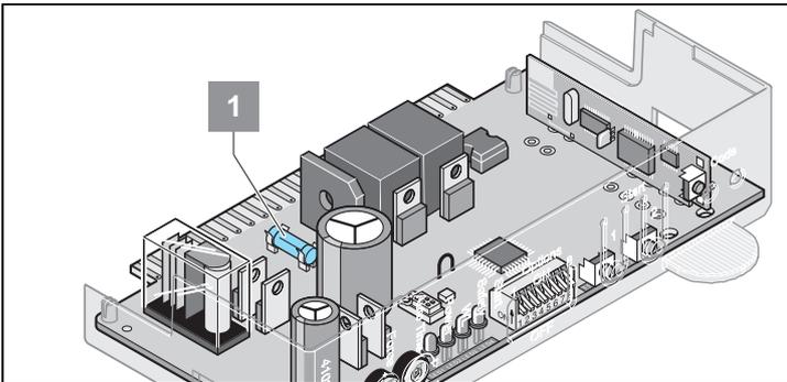
5. Steuerungsgehäuse öffnen und defekte Sicherung (1) austauschen.
