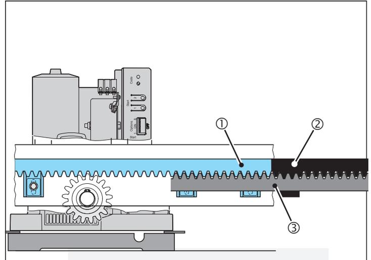
1. Zweite Zahnstange (2) bündig an erste Zahnstange (1) anlegen und eine zusätzliche Zahnstange (3) von unten so dagegenhalten, dass die Zähne der zusätzlichen Zahnstange (3) in die Zähne der oberen beiden Zahnstangen (1 u. 2) eingreifen. Somit wird eine optimale Passgenauigkeit der zweiten Zahnstange (2) gewährleistet.
