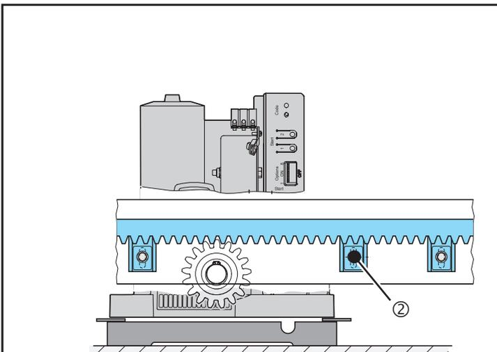
4. Tor soweit in „Zu“-Richtung schieben, bis der nächste Bohrpunkt gemäß der Abbildung positioniert ist und erneut anzeichnen.
