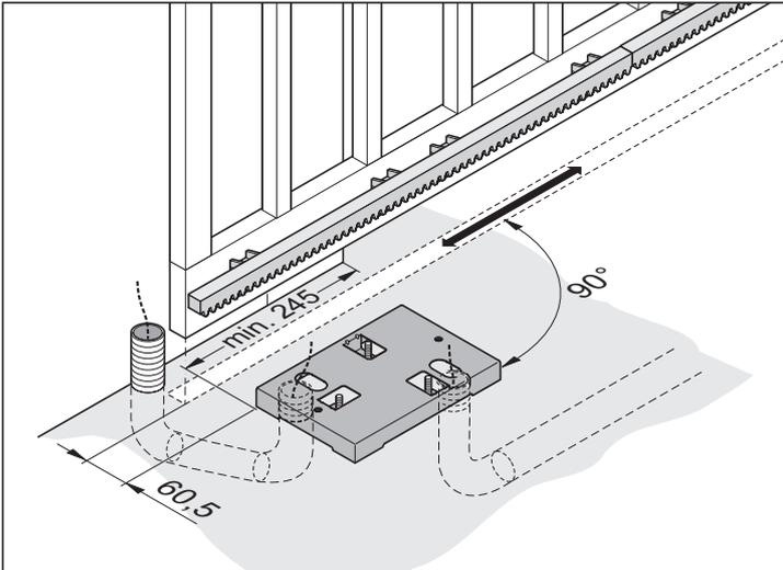
6. Maße der Konsole und Kabelkanäle für die Netzzuleitung und das Zubehör (z.B.: Lichtschränke) beim Aushub berücksichtigen, siehe Kapitel "Fundament".
