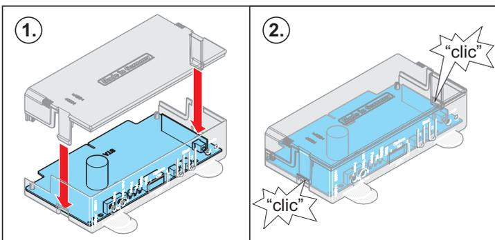
6. Steuerungsgehäuse schließen.
