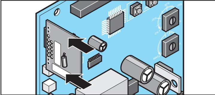
1. Die Empfängerplatine gemäß der Grafik auf die Steuerung stecken.
