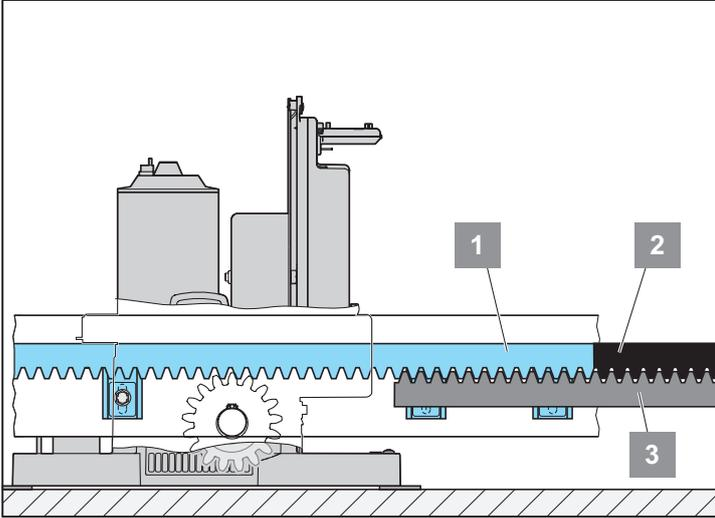
1. Zweite Zahnstange (2) bündig an erste Zahnstange (1) anlegen und eine zusätzliche Zahnstange (3) von unten so dagegenhalten, dass die Zähne der zusätzlichen Zahnstange (3) in die Zähne der oberen beiden Zahnstangen (1 u. 2) eingreifen. Somit wird eine optimale Passgenauigkeit der zweiten Zahnstange (2) gewährleistet
