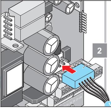
4. Abdeckung der Steuerungseinheit abnehmen und das zweite Ende des Verbindungskabels auf die Steuerung stecken (2)
