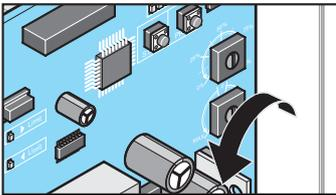
Potentiometer bis zur gewünschten OHZ nach links drehen
