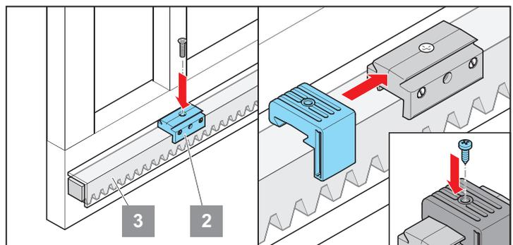
4. Unterteil (2) des Magnethalters an gewünschter Stelle mit der Zahnstangenabdeckung (3) verschrauben
