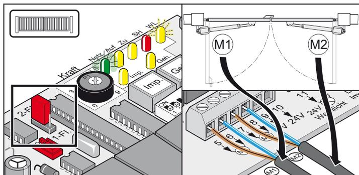
1. Antrieb an Steuerung anschließen
