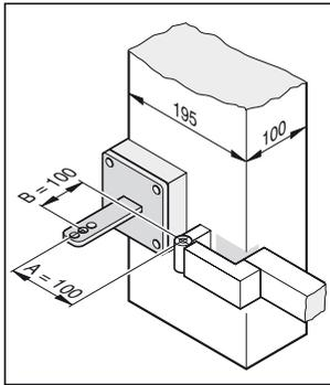
Da das B-Maß unter 100 mm beträgt, einen Abstandshalter unter den Pfostenbeschlag montieren. Somit wird das B-Maß auf 100 mm gebracht.
