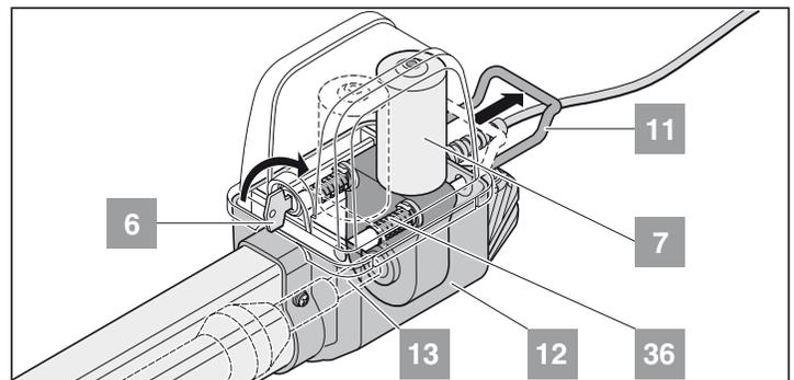
1. Schlüssel (6) 90° nach rechts drehen - Notlösebügel (11) wird entriegelt.
