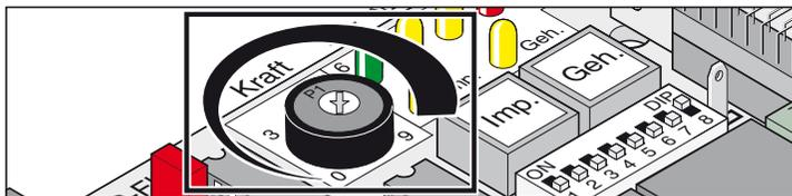
Einstellung der Krafttoleranz zur automatisch eingelernten Kraft. Die Einstellung des Potentiometer wird bei jedem Start neu eingelesen.
