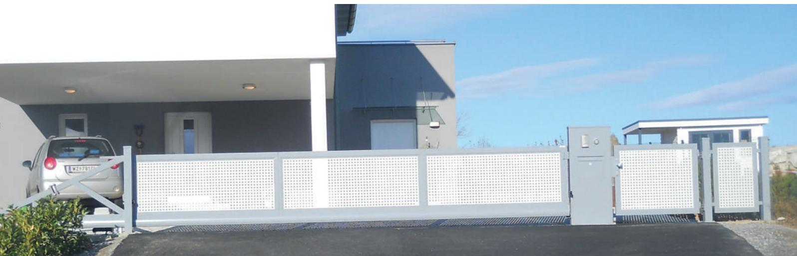
Lochblech Schiebetor, inkl. Postkastensäule mit Sprechanlage und Codetaster, Gehtüre und Zaun.
