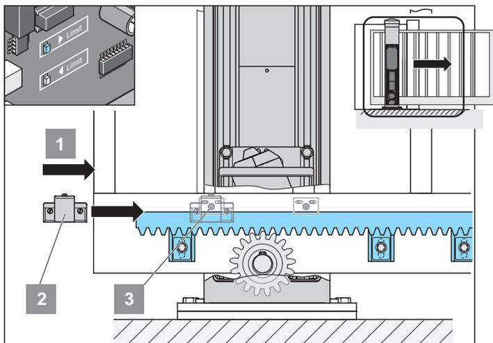
1. Sicherstellen, dass Antrieb entriegelt ist
