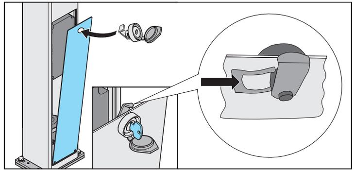
2. Revisionsklappe und Schloss gemäß Abbildung verbinden
