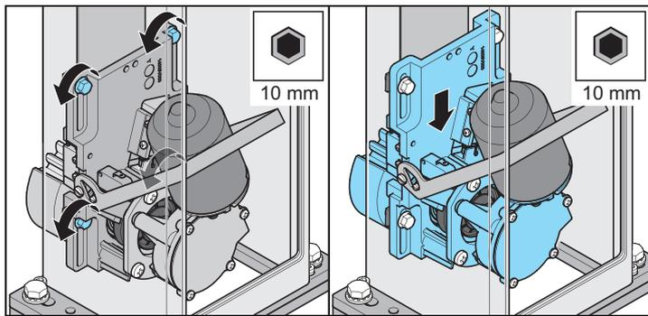
**Tipp: Vor dem Lösen der Schrauben die Position der Motoreinheit markieren**
