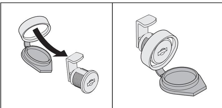
1. Staubkappe und Hebelschloss gemäß Abbildung zusammensetzen
