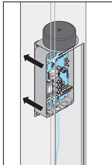
3. Steuerung durch die Reversionsöffnung auf das C-Profil auflegen
