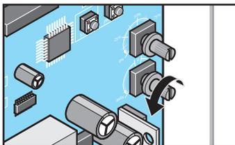
Potentiometer bis zur gewünschten OHZ nach links drehen
