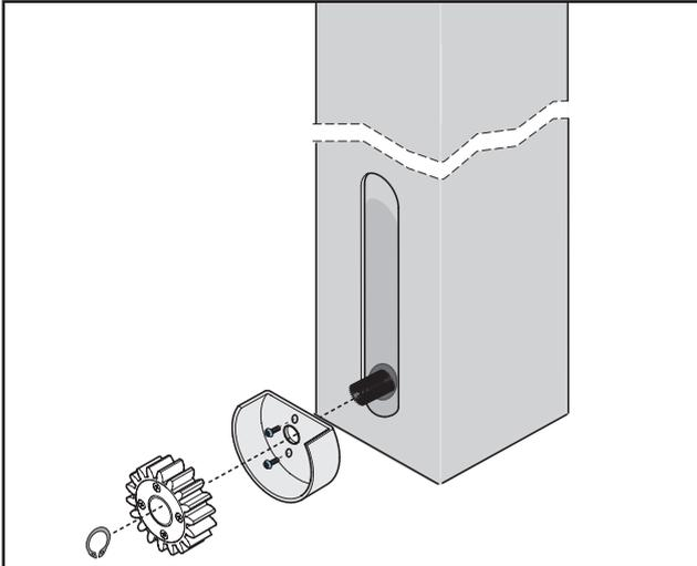
1. Eingriffschutz gemäß Abbildung aufsetzen und festschrauben
