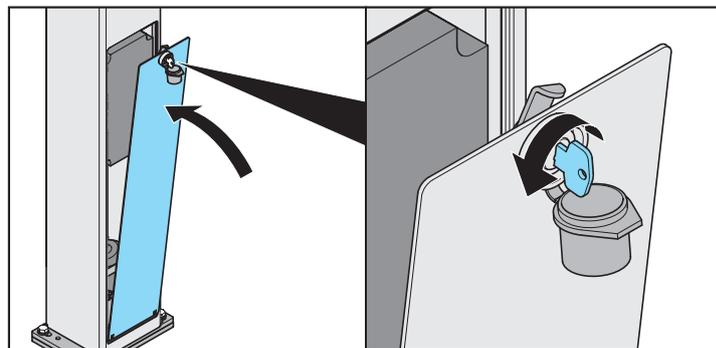
1. Revisionsklappe von unten ansetzen und nach oben klappen
