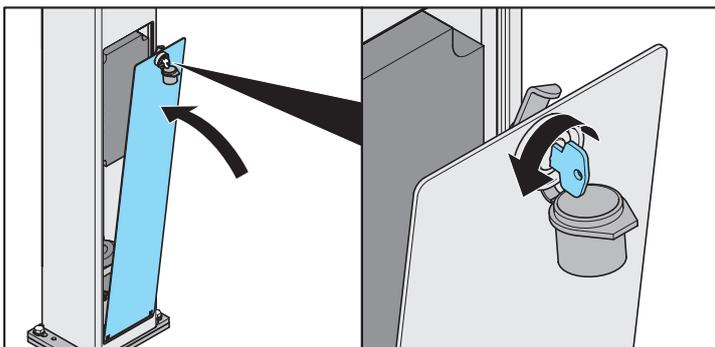
2. Revisionsklappe aufsetzen
