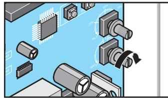
Potentiometer bis zur gewünschten OHZ nach rechts drehen
