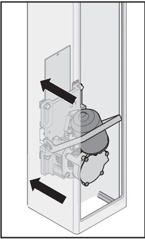
2. Antriebseinheit auf die selbe Weise montieren wie zuvor die Steuerungseinheit.
