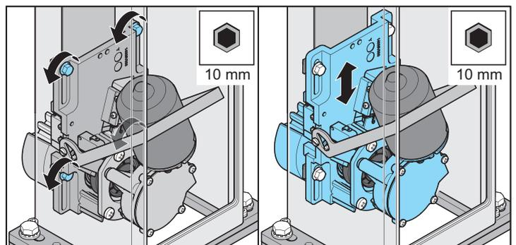
5. Die 4 Außensechskantschrauben (M6) lösen
