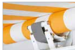
Bei größeren Breiten verhindert ein zusätzliches Rolltextlager einen Durchhang der Tuchwelle.
