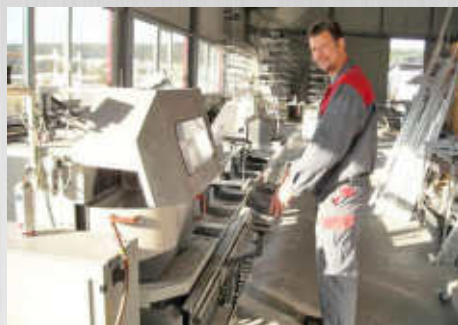
Zuschnitt mit der CNC - Doppelgehrungssäge
