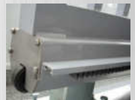
Einschiebbare Kunststoffzahnstange L= ca. 500 mm
